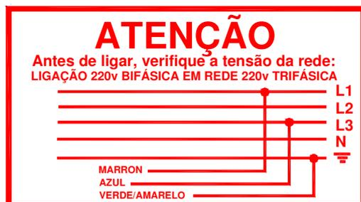
Adesivo de indicação da tensão elétrica, encontrado na extremidade do cabo elétrico de alimentação da máquina
